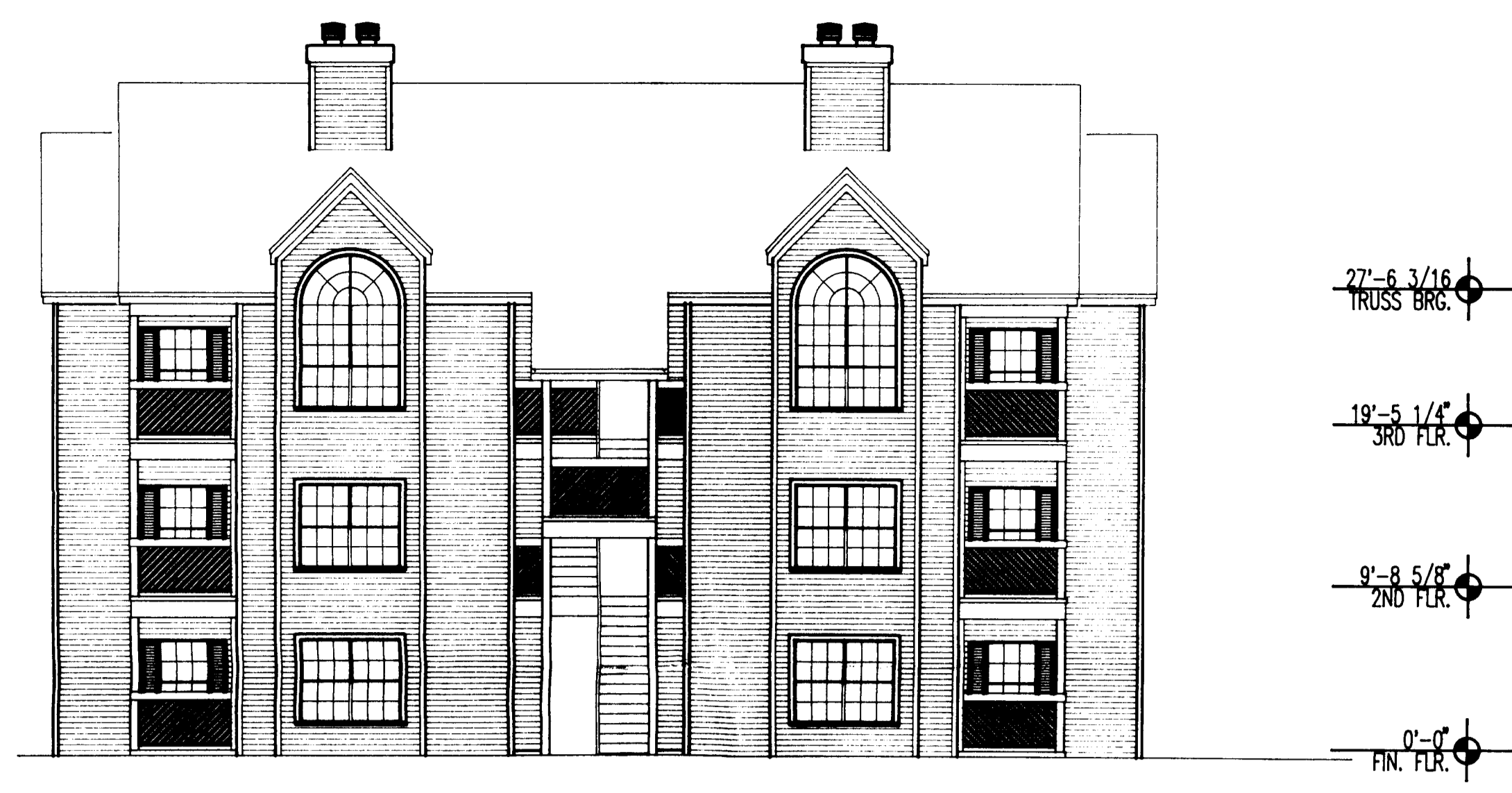
D6 ELEVATION - S1B - FRONT - TYPE I SCALE: 1/8" = 1'-0"
