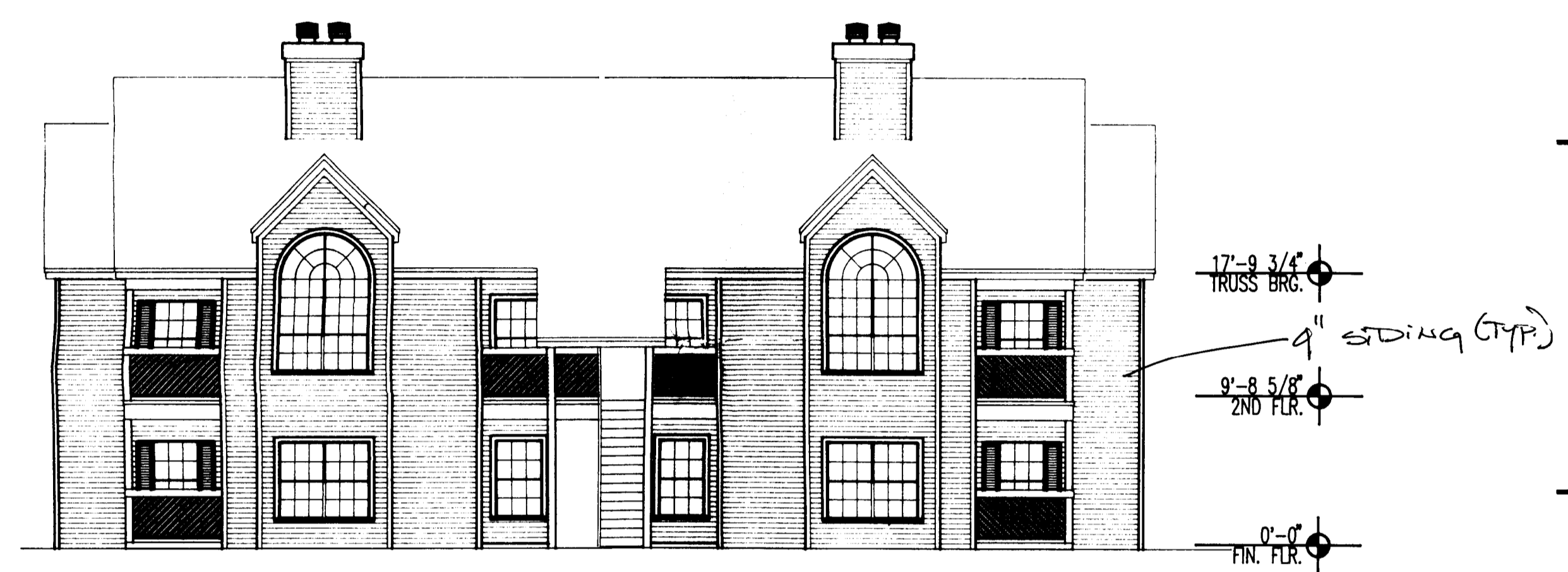
G6 ELEVATION - FRONT - L1B - TYPE I SCALE: 1/8" = 1'-0"
